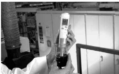
Рис. 24: Измерение pH значения проявителя в большой фотолаборатории
