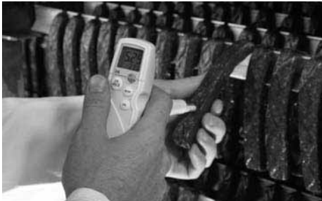
Рис. 22: рН измерение в процессе созревания колбасы
