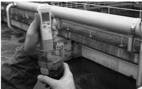
Рис. 23: Определения рН на биологическом этапе обработки сточных вод
