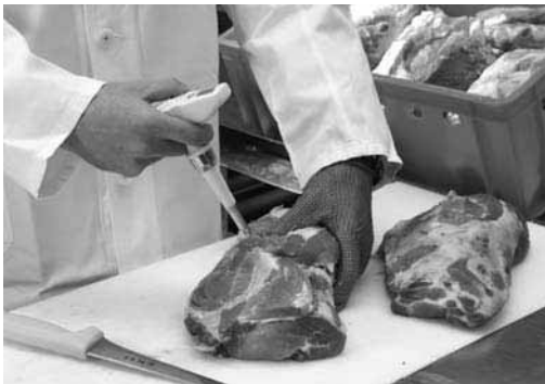
Рис. 20: Измерение pH в мясоперерабатывающей промышленности
