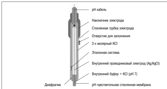
Рис. 9: Конструкция комбинированного электрода
