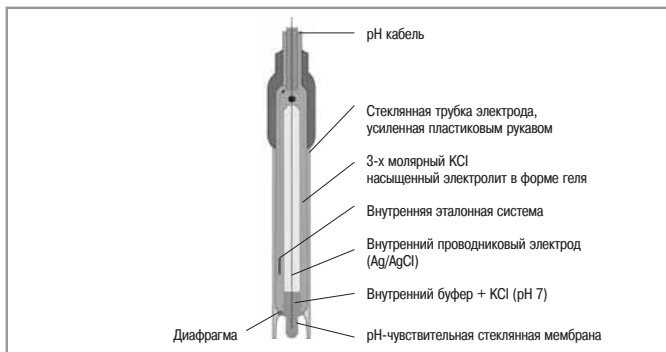
Рис. 10: Конструкция комбинированного электрода с гелевым электролитом
