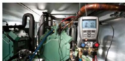
Аналіз ефективності роботи холодильної техніки манометричним колектором testo 570-2.
