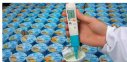
Контрольне вимірювання рН йогурту за допомогою рН-метра testo 206 pH2.
