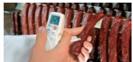
Контроль рН ковбасних виробів міцним проникаючим рН-метром testo 205.
