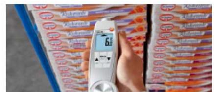
Безконтактний моніторинг температури замороженої піци приладом testo 104-IR.
