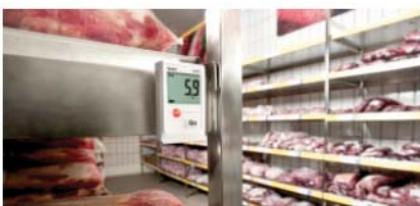
Моніторинг температури зберігання охолодженого м'яса реєстратором testo 174 T.
