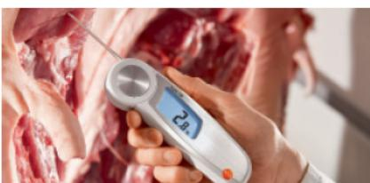
Контроль температури охолодженого м'яса термометром testo 104.
