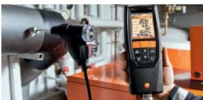
Наладка котла за допомогою газоаналізатора testo 320.
