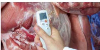
Вхідний контроль температури охолодженого м'яса за допомогою testo 105.
