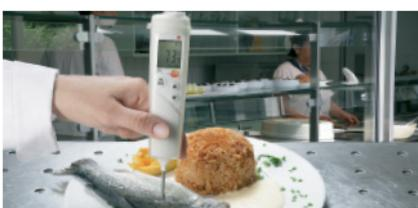
Контроль температури готової страви з риби термометром testo 106.
