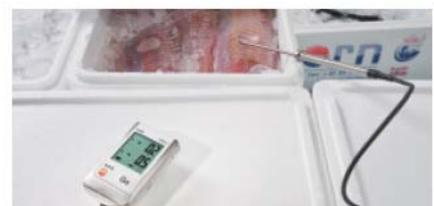
Одночасне вимірювання температури повітря та замороженої риби реєстратором testo 175 T2.
