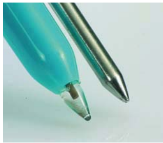
pH2 наконечник зонда для полутвердых субстанций
