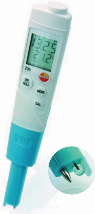
pH1 наконечник зонда для жидкостей
