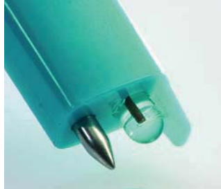
pH1 наконечник зонда для жидкостей
